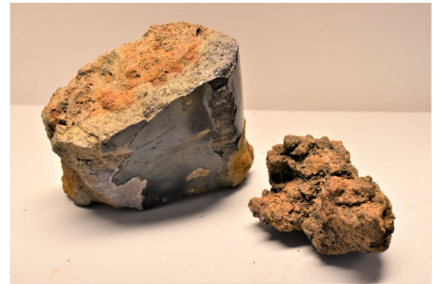
Verhüttungsschlacke und Ofenbruchstück einer Schmelzeinrichtung
